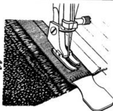
41 13 458-01,30 mm, 41 13 458-02,45 mm. Rya-liniaal. De wol wordt om de liniaal gewikkeld en met een rechte steek vastgenaaid. Speciaalvoetje 41 12 964-01
