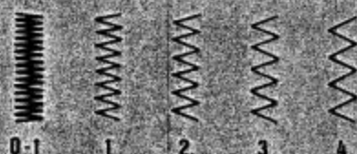
Instelling van de steeklengte
