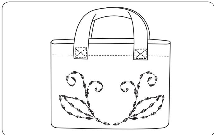
I motivi da 35 a 36 (modalità 2) sono punti speciali per una trapuntatura apparentemente fatta a mano. Utilizzare un filo di nylon trasparente per l'ago e il filo di cucitura standard per la spoletta. Il filo della spoletta viene sollevato sul lato destro del tessuto e i punti hanno l'aspetto di punti fatti a mano.
