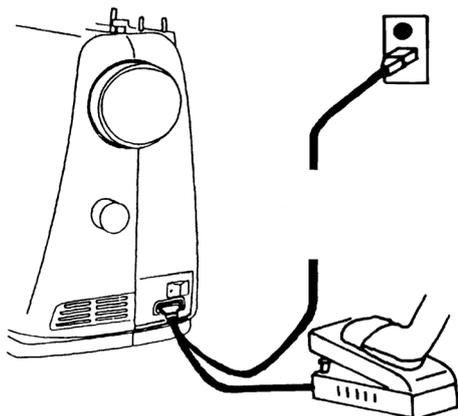
L'interrupteur de courant allume aussi bien la machine que la lampe de la machine à coudre.
