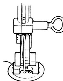
Pour les boutons comportant quatre trous, le tissu est déplacé avec le bouton : 6 à 7 points sont ensuite à nouveau cousus dans les autres trous. Une fois le tissu retiré, couper le fil supérieur en laissant une certaine longueur, l'amener sur l'envers du tissu et le nouer au fil inférieur.
