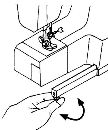
Le pied réglable (17) permet d'ajuster la stabilité de la machine à coudre.
