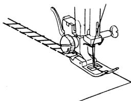
Placer le tissu sous le pied de façon à ce que les points soient effectués au-dessus des bords. Abaisser le pied-de-biche et commencer la couture en guidant légèrement le tissu.
