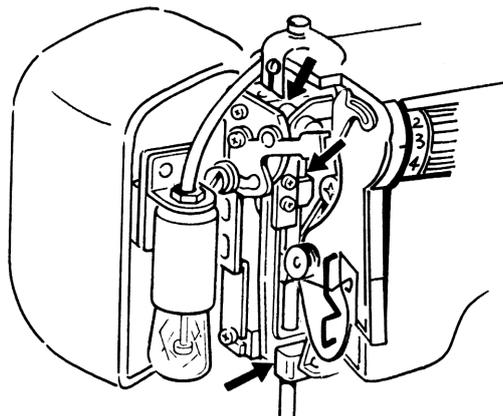
Si la machine ne fonctionne plus correctement suite à une longue période d'inutilisation, faire tourner rapidement la machine huilée, couvercle frontal (21) fermé, pendant environ une minute.
