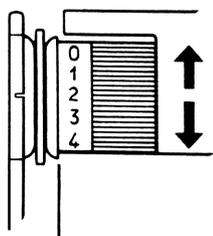
La tension est générée par les disques par lesquels passe le fil. La pression sur ces disques est réglée par la roulette de réglage de la tension du fil supérieur (2).
