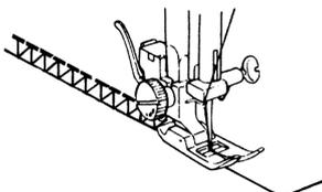
Placer le bord du tissu sous le pied-de-biche de façon à ce que l'aiguille subissant une déviation à droite couse un point droit, tout en restant en contact avec le bord du tissu de manière à coudre un point zigzag avec la déviation à gauche.
