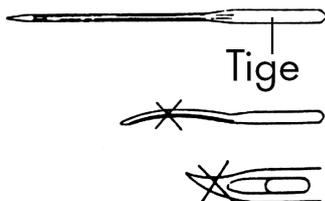
Le chiffre indiquant la grosseur de l'aiguille figure sur la tige. Plus le chiffre est élevé, plus l'aiguille est grosse.
