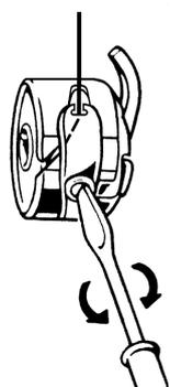
Pour modifier le réglage de la tension du fil inférieur, utiliser la vis de réglage de la boîte à canette. Pour effectuer le réglage, utiliser le petit tournevis fourni.
